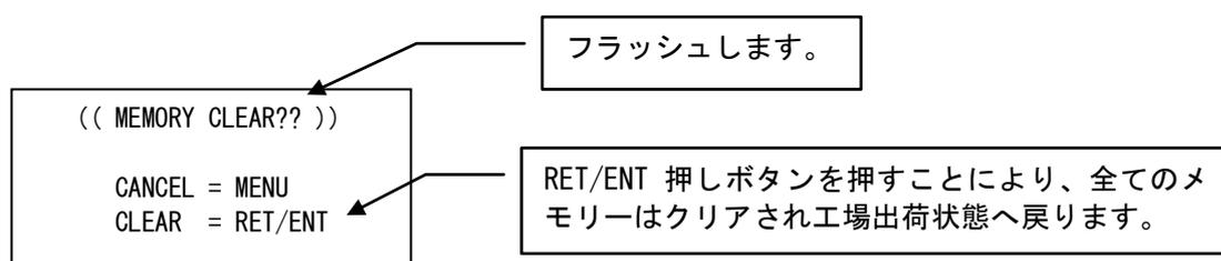
フロントのRET/ENT押しボタンを押すと、メモリークリアを実行し、本機が自動的に再起動します。
